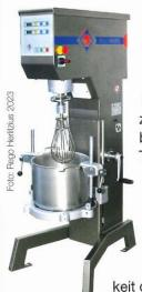
Rotec 2000 mit nach München. Die Schlag- und Rührmaschinen bietet der Maschinenbauer in unterschiedlichen Größen mit Fassungsvermögen von zehn bis 60 Litern an. Dabei könne zudem zwischen Tischmaschinen und kompakten Standmaschinen ausgewählt werden. In Bezug auf ihre Planetenmaschinen unterstreicht Rego Herlitzus die Zuverlässigkeit und Langlebig-
