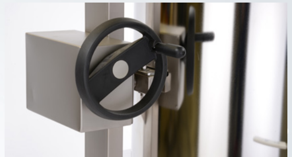
Handrad zur kontrollierten Entleerung
